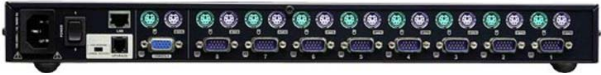
圖 3. 8 port IP KVM 切換器，先把一組鍵盤、螢幕和滑鼠接在最左邊的插座，就可以連接 8 台電腦主機進行切換控制，也可以透過網路連線從遠端進行管理，而不用進入機房操作。
