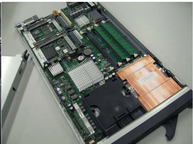
圖 5. 刀鋒伺服器單一「刀片」內容，由於電源、散熱風扇、光碟、軟碟等已由機箱提供，伺服器不需要再裝這些零件，可以使體積更小。
