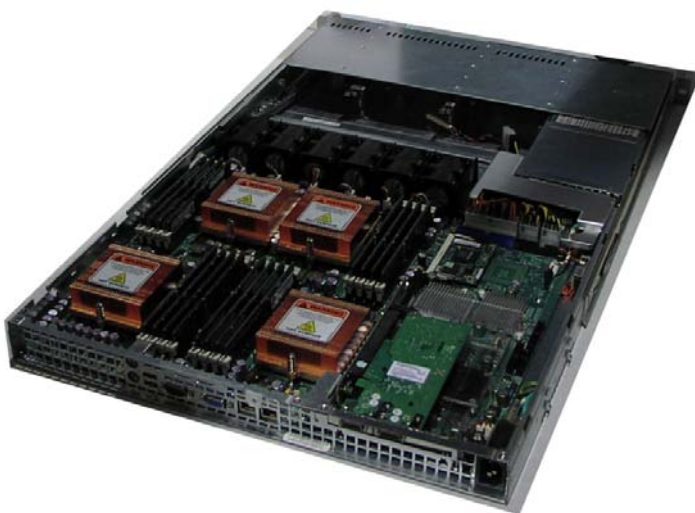
圖 2. 配備四顆四核中央處理器的網路伺服器，可以達到相當於 16 顆單核心處理器的效果。
