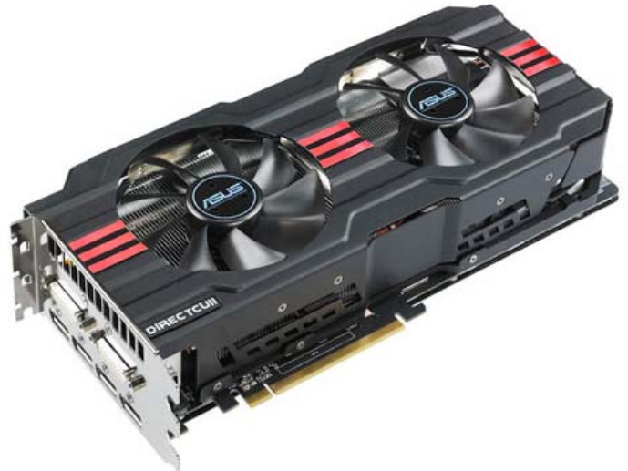
圖 1.華碩 HD 7970 DirectCU II 顯示卡，內含 3GB DDR5 記憶體，處理時脈達 1000MHz，還配備兩顆風扇來散熱，可同時支援 6 部顯示器。
