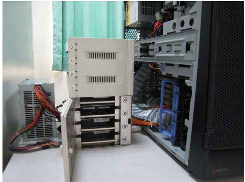
圖 10. 高雄場第一個磁碟陣列系統，由 8 顆 160GB IDE 硬碟組成，採用 RAID 5 技術，總容量 960GB
