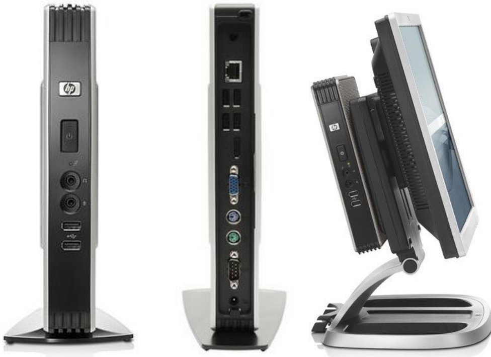
圖 3. 簡易型上網設備 Think Client，這種設備可以連結螢幕、鍵盤和滑鼠及網路線，開機後即可直接連線登入虛擬電腦操作。由於不具有硬碟等需要馬達帶動的配備，因此耗電量很低又不易損壞；而且體積很小，可以直接裝在液晶螢幕後面，節省桌面空間。
